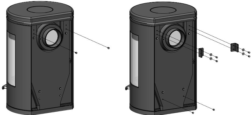
Il corpo della stufa deve essere sollevato nella posizione di installazione, in modo tale che la base poggi su lato inferiore dell'attacco a muro. La stufa deve essere fissata superiormente mediante le 2 viti M5x12 fornite, e inferiormente mediante 2 viti M8x20 e le rondelle fornite in dotazione (vedi schema). Per l'esecuzione di questa operazione è vivamente consigliabile utilizzare 2 persone.
