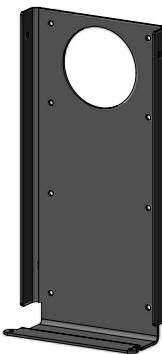
Het wandmontageframe kan worden gebruikt als boorschijabloon. De minimale afstand tot een brandbare ondergrond bedraagt 275 mm.
