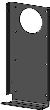
El bastidor de montaje en pared se puede utilizar como plantilla de taladrado. La separación mínima a un suelo inflamable es 275 mm.
